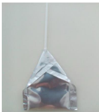
Gambar 1. Lipatan kantong aluminium foil (Sunarno dan Sariadji)
