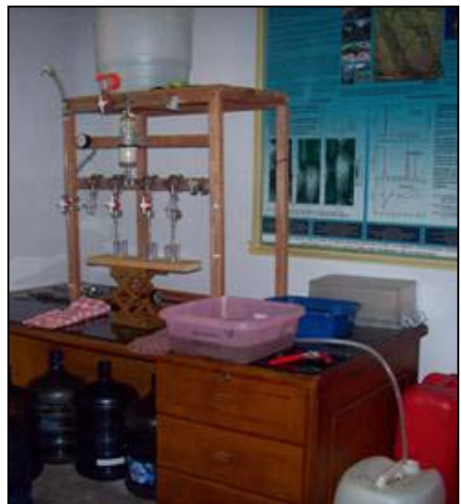
Gambar 1. Sistem Sperry untuk mengukur hydraulic conductivity akar
